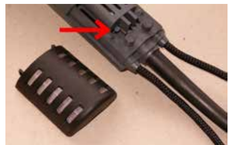
Overbelastningsvern på modeller levert før mars 2010 har egen knapp som skal nullstilles.
