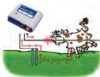
Normalt stängsel. Jordning fungerar som normalt.
