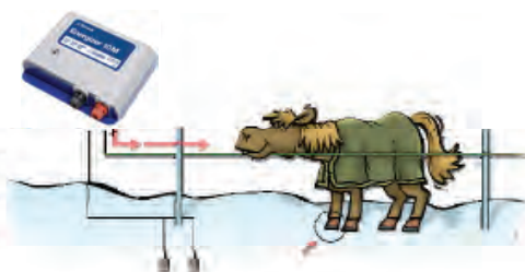
Under vintern när jorden är tjälad, fungerar jordning dåligt eller fungerar inte alls och djuren får ingen stöt.
